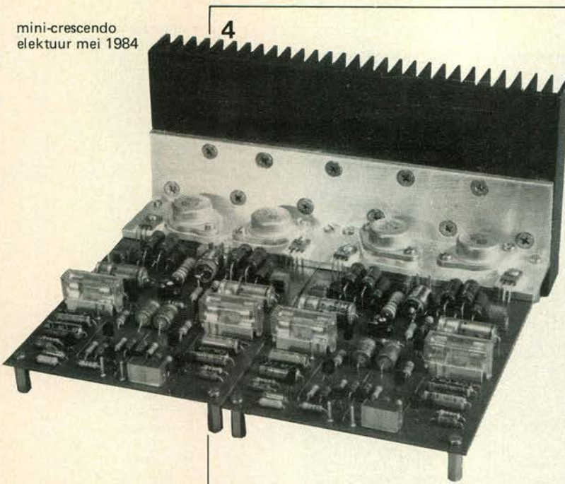
Figuur 4. Een complete versterkermodule, bestaande uit twee printen welke door middel van een aluminium hoekprofiel tegen het koellichaam zijn bevestigd.
